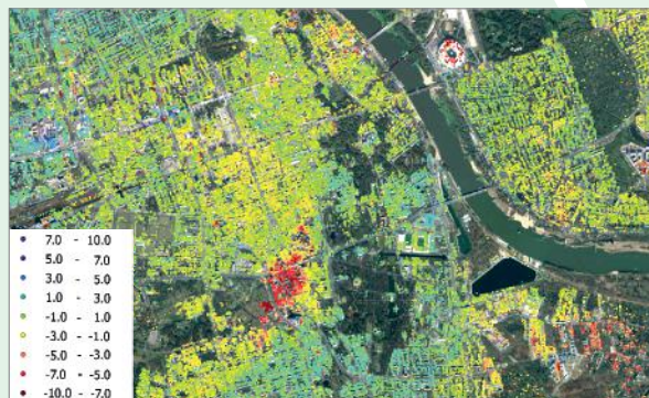
Ryc. 2. Wynik projektu DefSAR przedstawiający deformacje powstałe na terenie Warszawy (źródło: Instytut Geodezji i Kartografii)
