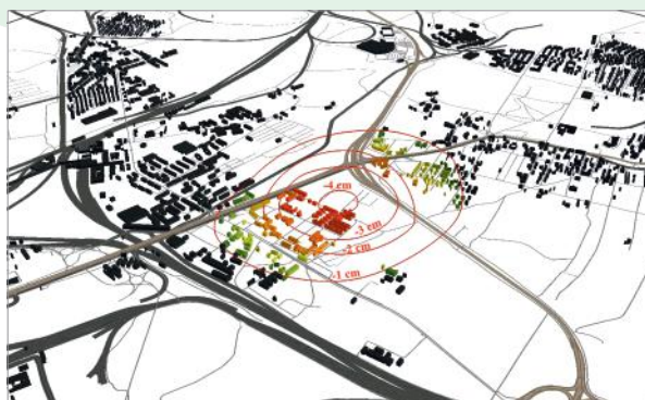
Ryc. 1. Mapa izolinii pionowych przemieszczeń terenu powstałych w centrum Bytomia (źródło: Satim Monitoring Satelitarny sp. z o.o.)
