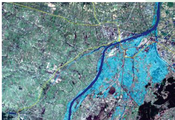
Ryc. 2. Zasięg powodzi wyznaczony na podstawie radarowych obrazów satelitarnych w ramach projektu SAFER, okolice Sandomierza (źródło: http://sertit.u-strasbg.fr/ )
