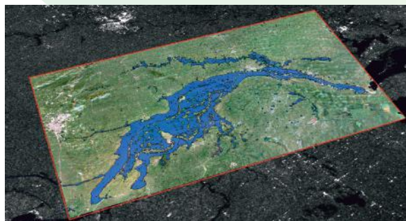
Ryc. 1. Zasięg powodzi wyznaczony na podstawie zobrażeń radarowych Envisat (Europejska Agencja Kosmiczna), która wystąpiła w Chinach w 2007 r. (źródło: Satim Monitoring Satelitarny sp. z o.o.)
