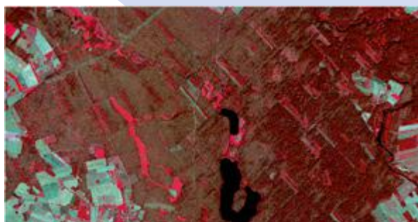
Ryc. 15. Wysokorozdzielcze zobrazowanie satelitarne Kompsat-3A wykonane po nawałnicy w Borach Tucholskich (11/12.08.2017 r.) na terenie Nadleśnictwa Lipusz; u góry - kompozycja RGB (barwy naturalne), u dołu kompozycja z użyciem bliskiej podczerwieni (barwy fałszywe) (źródło: KOMPSAT-3A imagery ©KARI, distributed SIIS)
